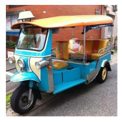
La plupart des tuk-tuk taxi peuvent transporter trois adultes. Ce taxi fonctionne à l'essence ou au gaz. Il y a un siège pour le conducteur à l'avant et un siège pour les passagers à l'arrière. La partie avant est construite à partir d'une moto ou d'un scooter.
